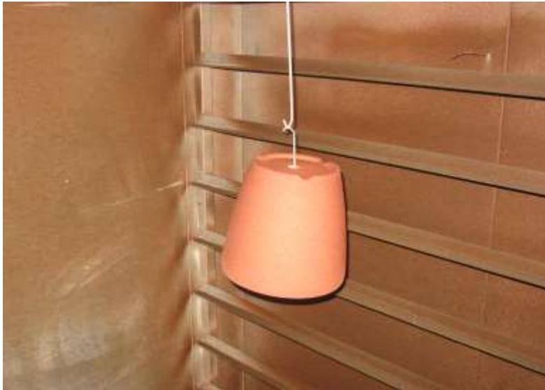
Figura 3: inserimento in forno, insieme al supporto, per completare la reticolazione
