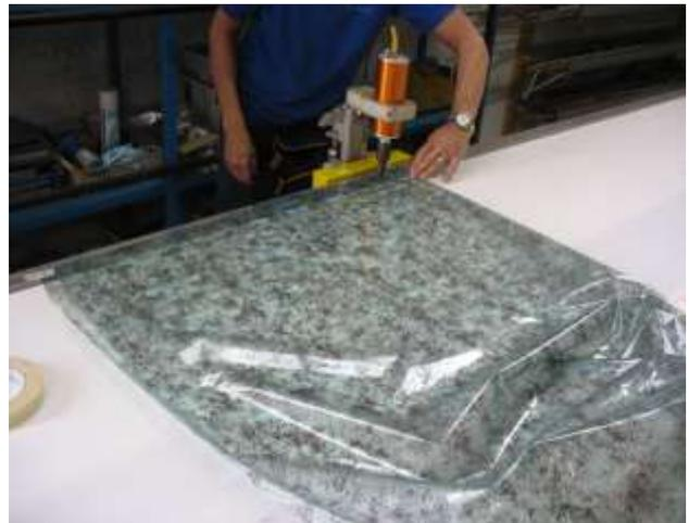
Figura 6: si salda il terzo lato, chiudendo il film a sacchetto
