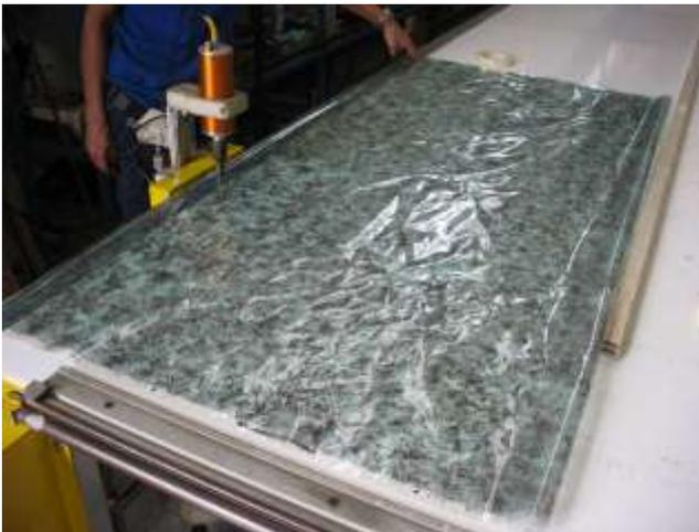
Figura 5: due estremità del foglio di film vengono saldate
