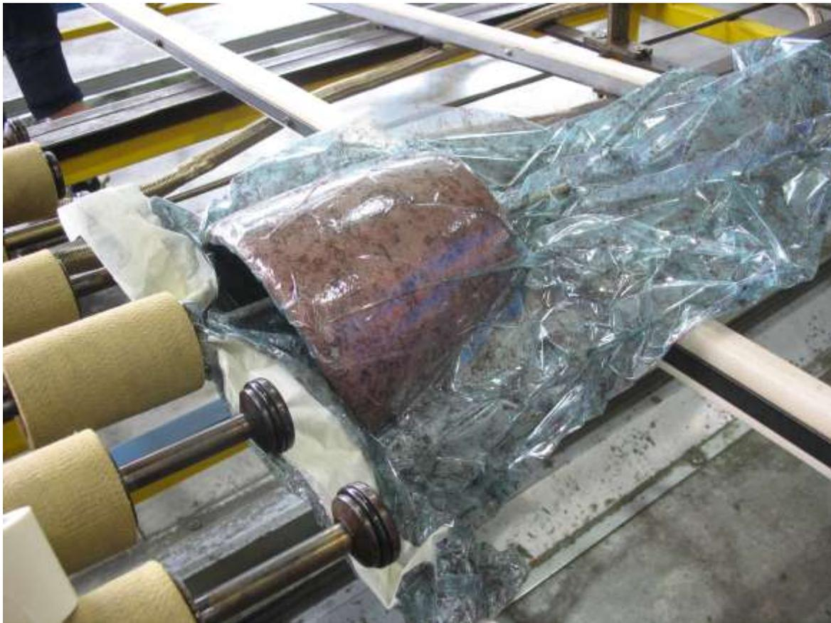
Figura 9: il vaso nel suo imbustamento viene collegato alla testa aspirante e portato sotto vuoto
