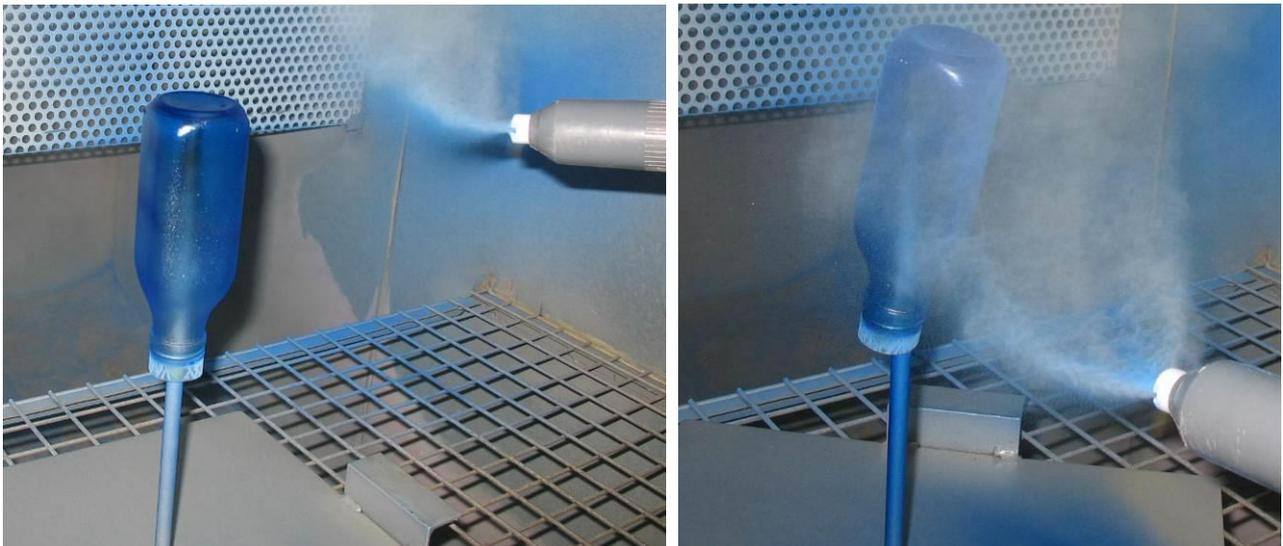
Figure 7 e 8: applicazione a caldo della polvere
