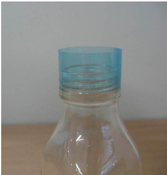
**Figura 4:** protezione delle parti da non verniciare
