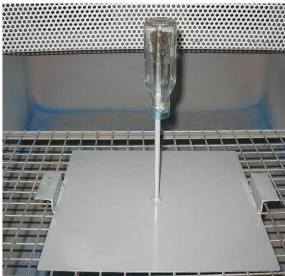
**Figura 6:** preparazione sul supporto per verniciatura
