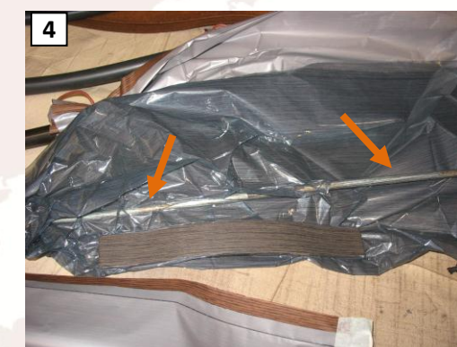
4 È importante l'aderenza del film su tutta la superficie da decorare dell'oggetto: per questo si usa un ulteriore tubo aspirante interno
