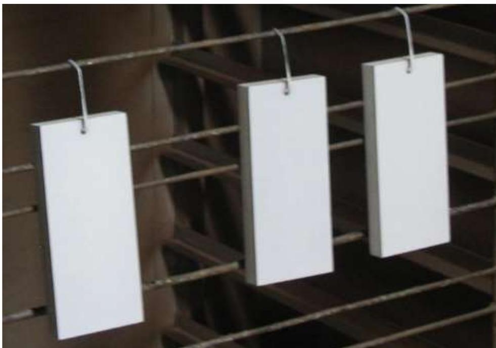
**Figura 5:** Campione verniciato posto in forno per la reticolazione a 160°C
