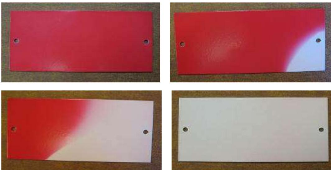
Lamierino verniciato doppia mano con *Thermo-003* su base bianca *PE 411*: il riscaldamento sopra i 28°C fa scolorire la polvere termocromica dello strato superiore, che lascia così trasparire la base bianca del *PE 411* sottostante.
