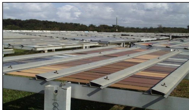
Figure: Esposizione naturale, campioni esposti all'AWSG in Florida Pictures: Florida Natural Exposure, test samples
