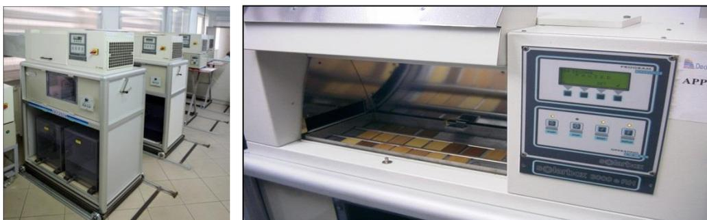
Figure: apparecchiature per l'invecchiamento accelerato.
