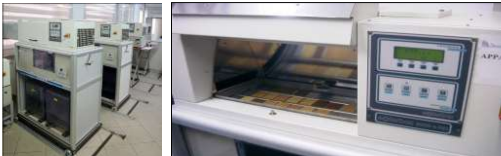
Figure: apparecchiature per l'invecchiamento accelerato. Pictures: equipment for the Accelerated Weathering Test
