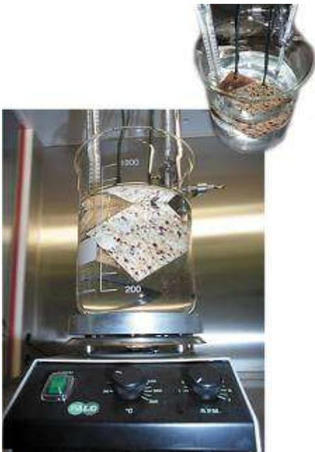
La prova distruttiva, fornisce indicazioni sulla resistenza al distacco del film di vernice dal supporto, in condizioni di immersione o di elevata condensa.
