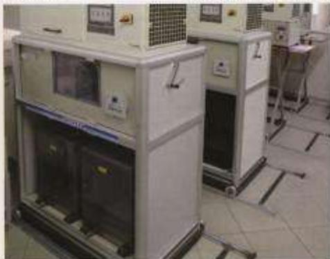
Fig. 2 Apparecchiature per l'invecchiamento accelerato
