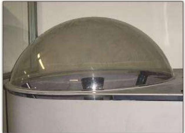
La prova AASS è particolarmente adatta per sottoporre a prova rivestimenti organici su alluminio e sue leghe.
