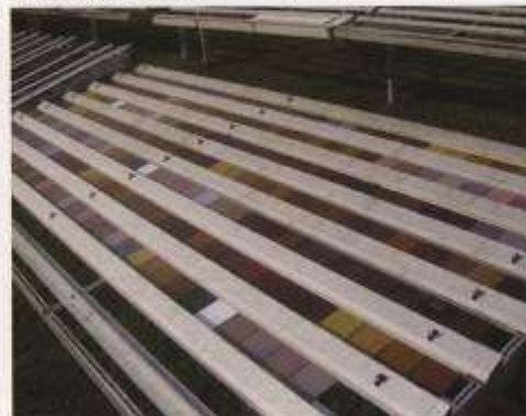
Fig. 3 Esposizione naturale, campioni esposti all'AWSG in Florida
