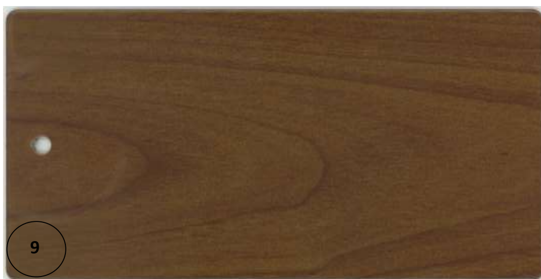
Figura 9: Lamierino sovraverniciato e decorato su Ironsafe-01 dopo il test di resistenza in pentola a pressione.
