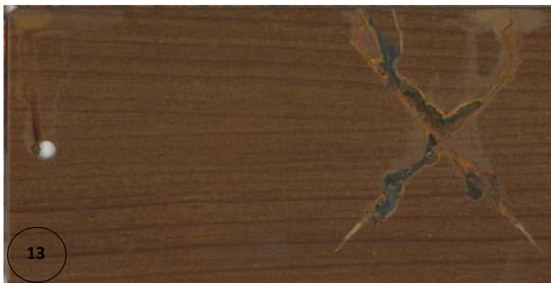
Figura 13: Lamierino sovraverniciato e decorato su Ironsafe-01 dopo il test della nebbia salina.
