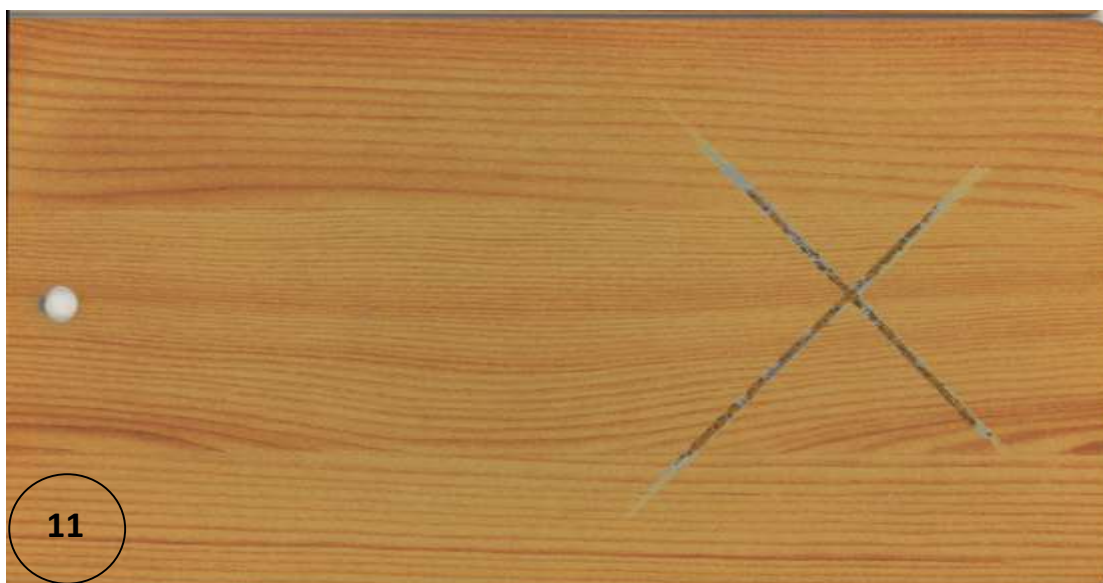
Figura 11: Lamierino verniciato e decorato su Ironsafe-01 dopo il test dell'umidostato.
